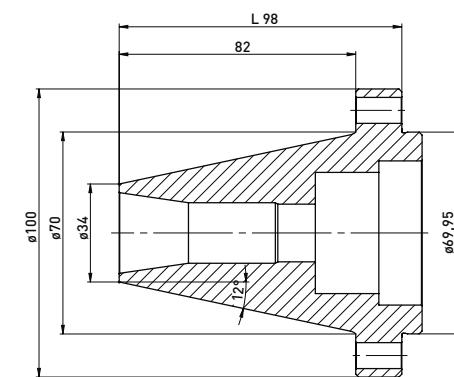
COBRA SK50 für Walter Maschinen, Ausführung für **NANN** Spannzangen.
