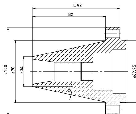
COBRA SK50 für Walter Maschinen, Ausführung für **NANN** Spannzangen.
